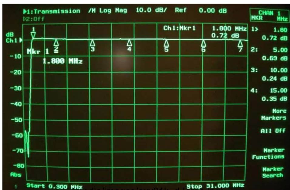
AVV 01 K Übertragungsbereich, hier nur bis Marker 4 ( 15,0 MHz ) als Messwert gezeigt, mit Sperrfilter < 1,8 MHz
