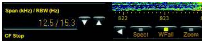
Abbildung 3: Die Pegel der Marker folgen der Auflösungsbandbreite (RBW), die in einem der Fenster links im Perseus in Hertz angezeigt wird.
